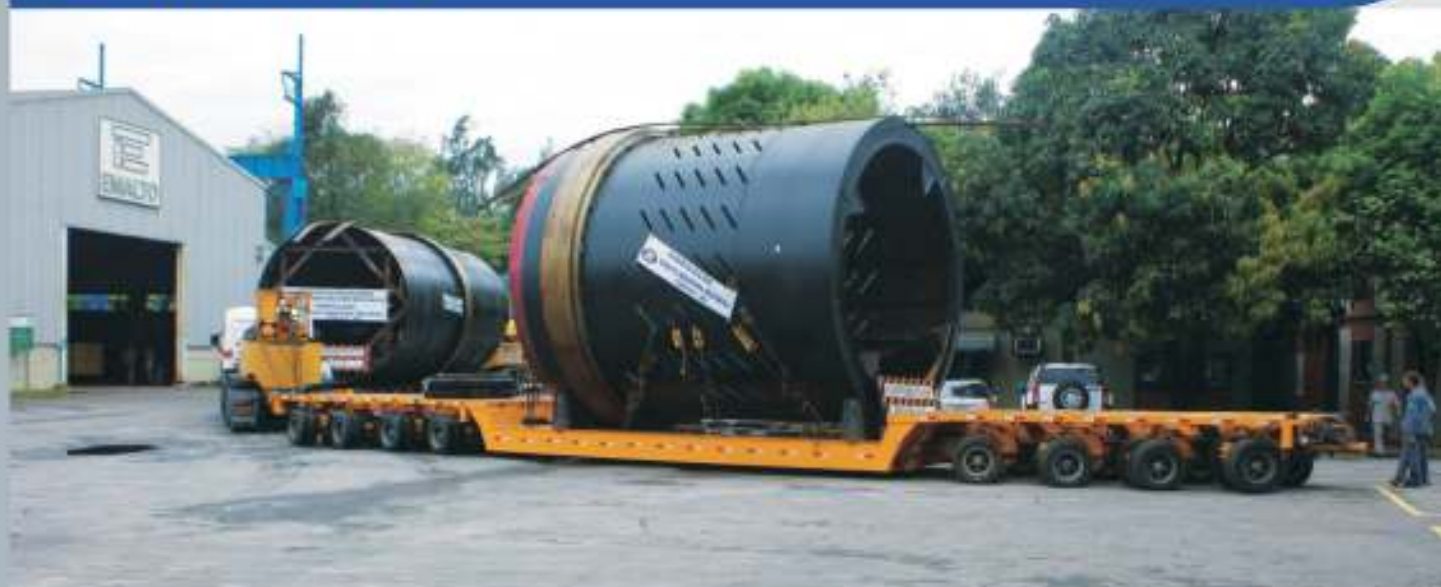
Tambor Descascador de Toras, fabricado para a Internacional Paper com peso total de 260 Ton
